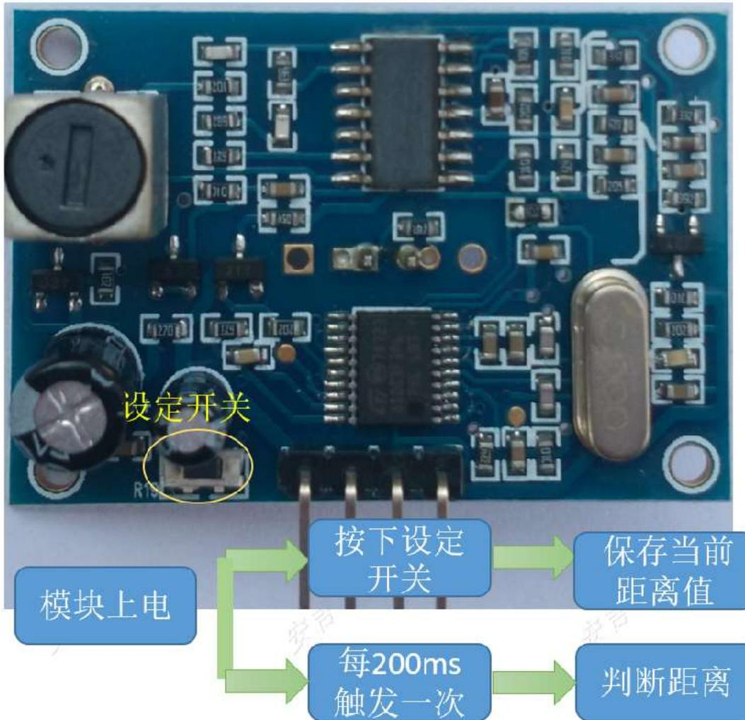
开关量模式引脚定义: Trig→默认高电平为工作, 置低电平模块暂停工作
