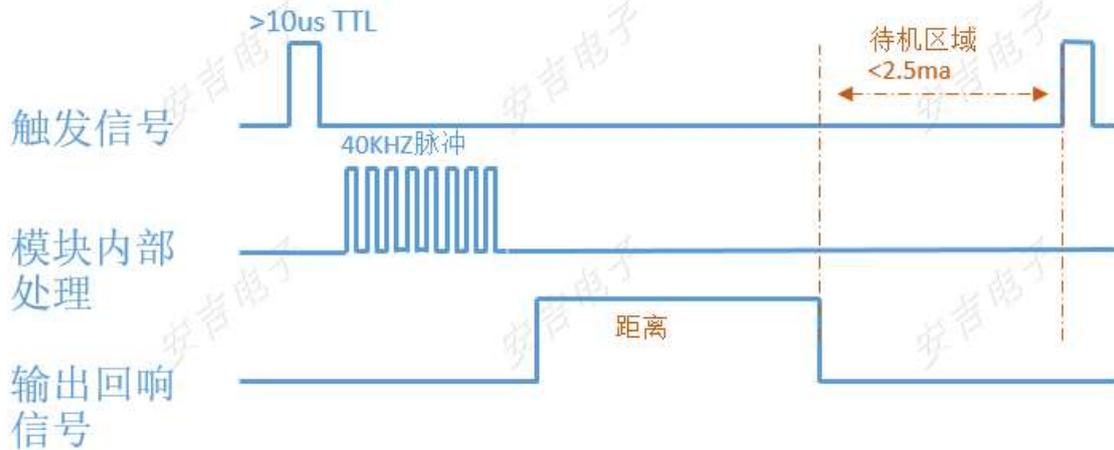
模式1引脚定义: Trig→触发信号
