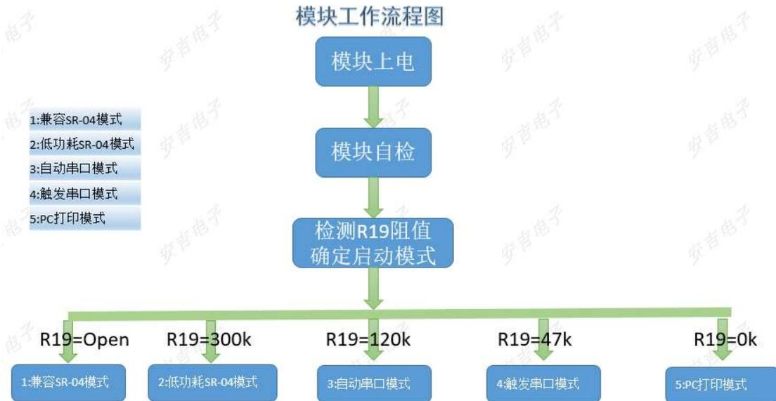
模式1: 待机电流<2.0ma,工作电流30ma
