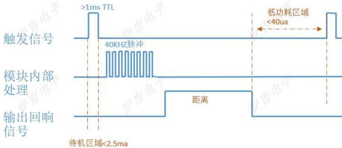
模式2引脚定义: Trig→触发信号
