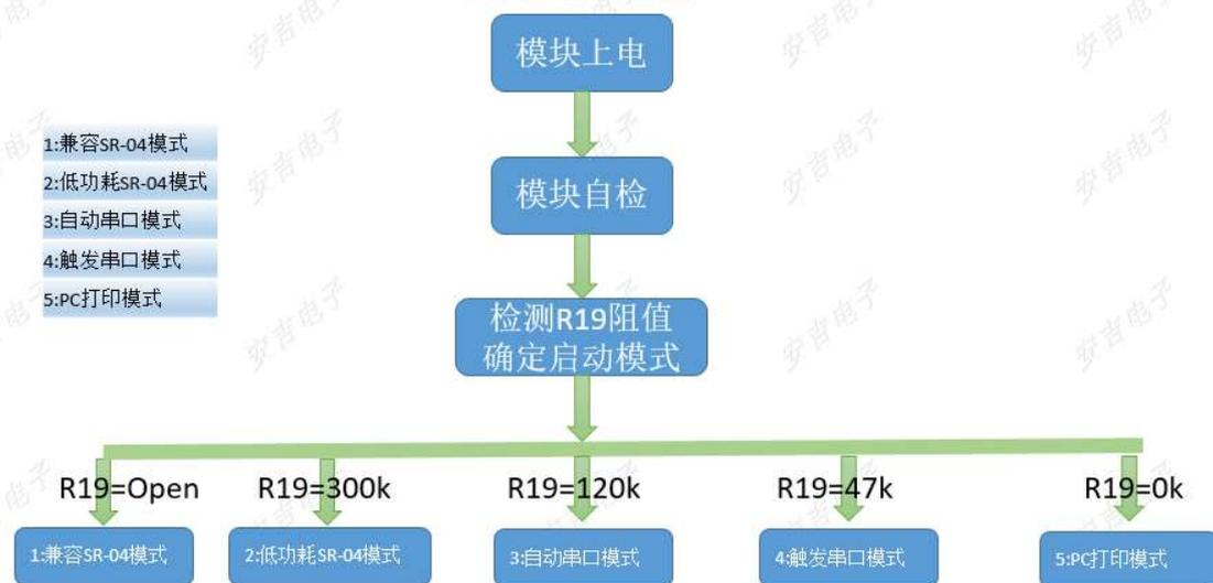
模式1: 待机电流<2.0ma,工作电流30ma
